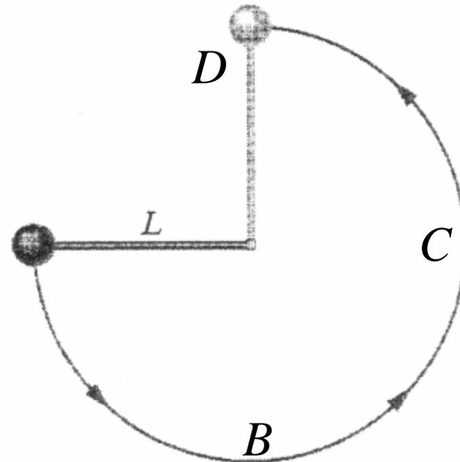
A velocidade mínima corresponde á tensão nula no fio  $v_{\min} = \sqrt{gL}$
