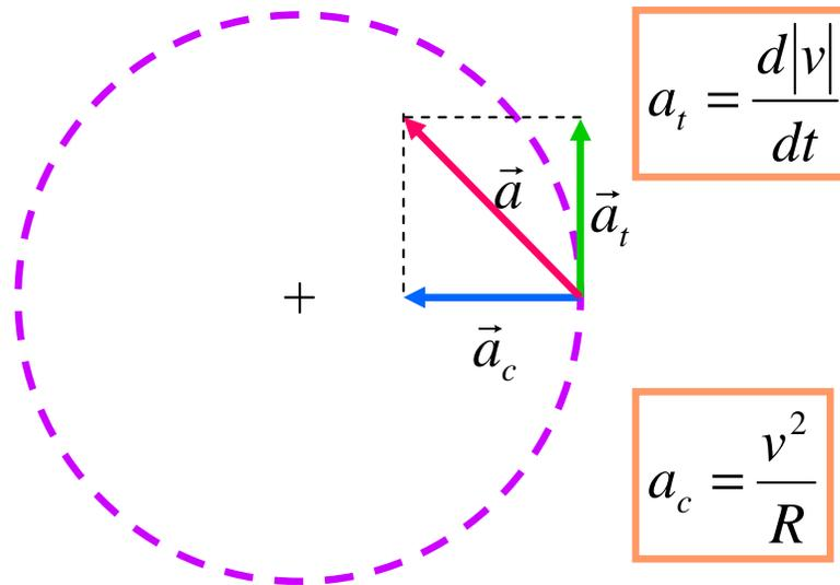
1. A **aceleração normal** ou **centrípeta** é normal à velocidade e aponta para dentro do círculo
