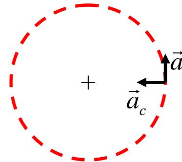
A aceleração tangencial é colinear com a velocidade e portanto tangente à trajectória.
