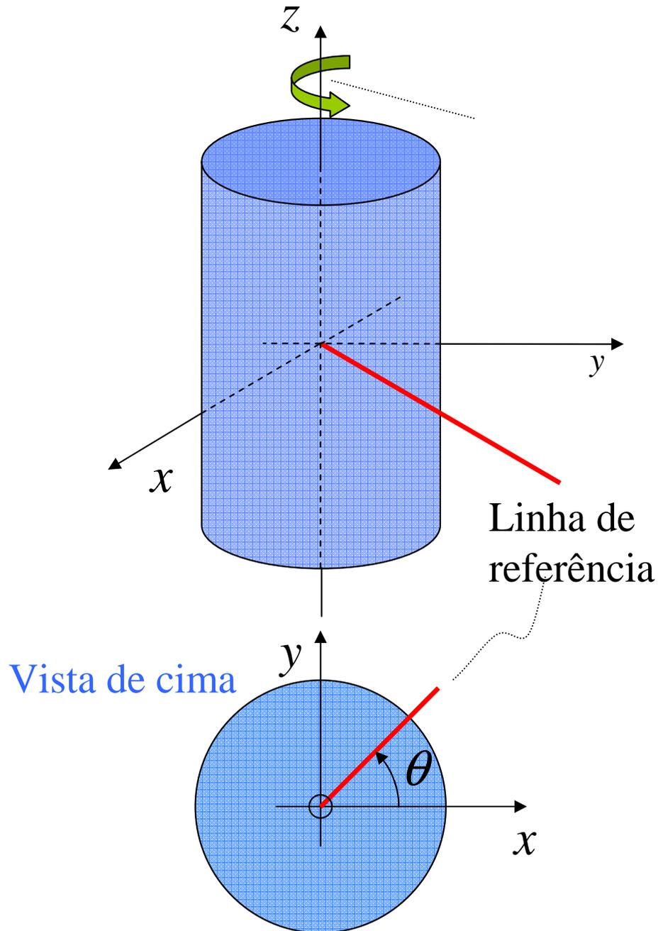
Todas as partículas do corpo rígido rodam com a **mesma velocidade angular** em torno do eixo fixo de rotação.
