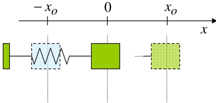
*Sistema mola + massa deslizando sobre uma superfície sem atrito*
