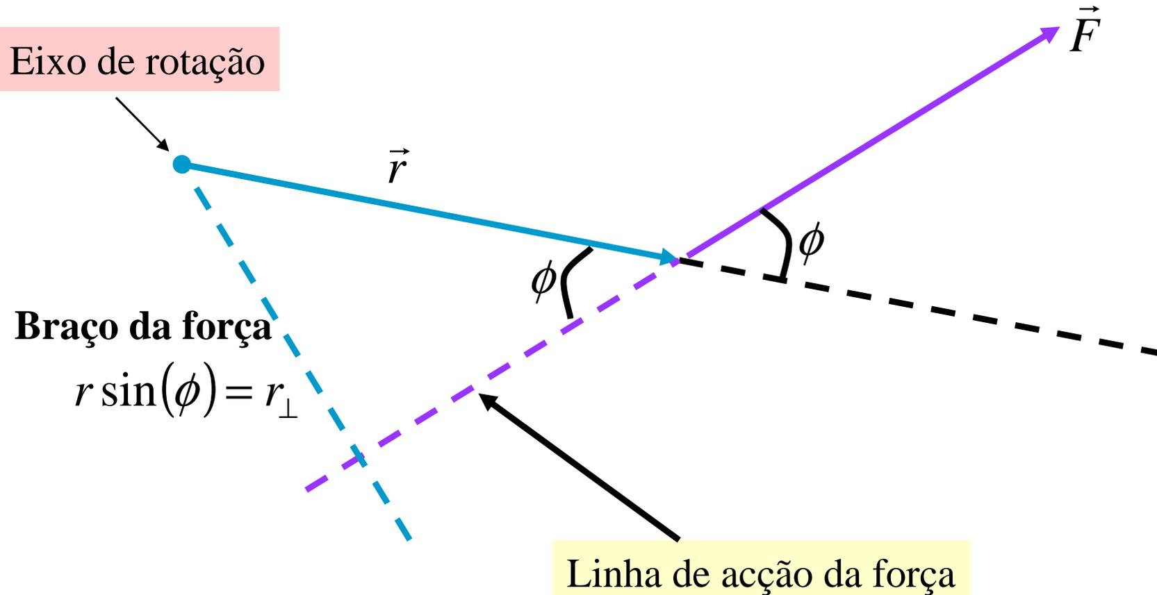
**Braço da força** – distância do eixo à linha de aplicação da força
