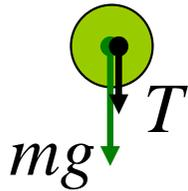
$$\begin{aligned} \text{Pela 2ª Lei, } mg + T &= ma_c \\ &= m \frac{v^2}{L} \end{aligned}$$
