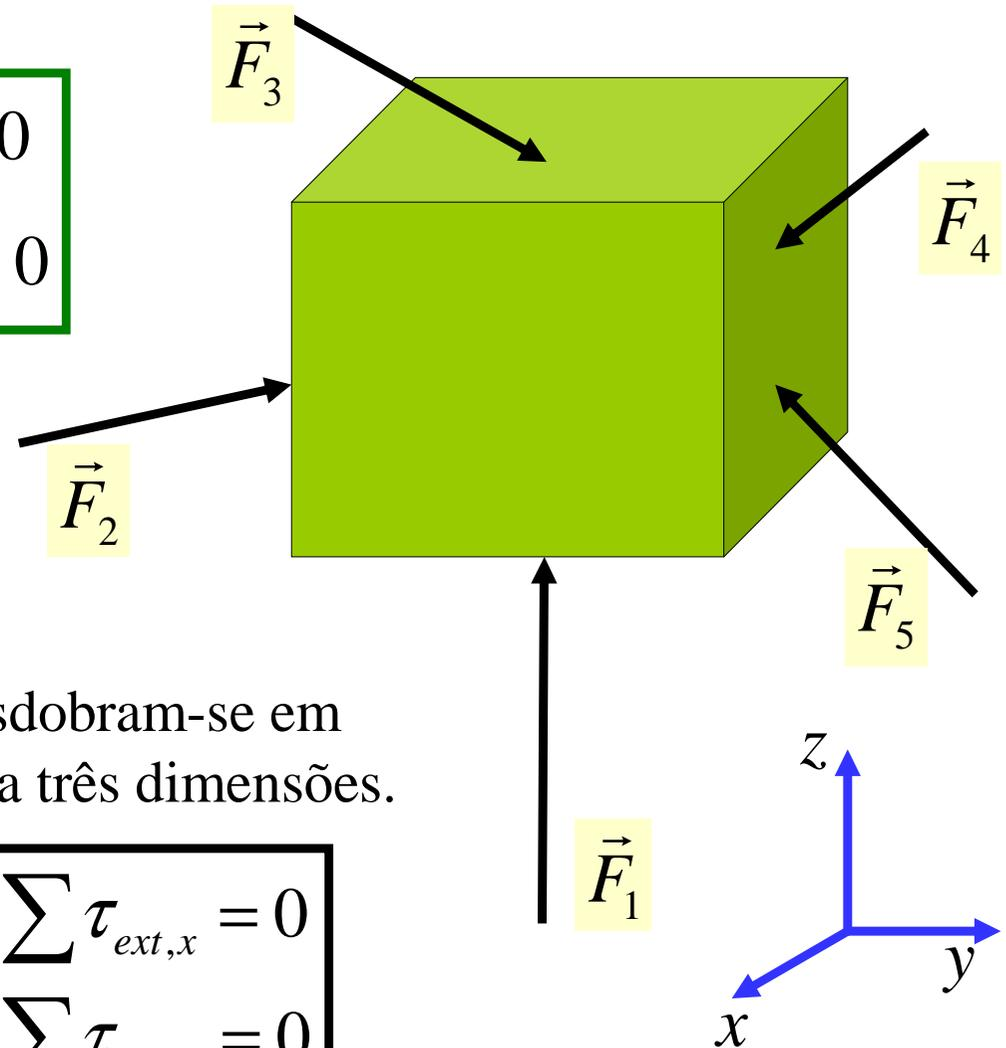
As anteriores equações vectoriais desdobram-se em três equações escalares, num espaço a três dimensões.
