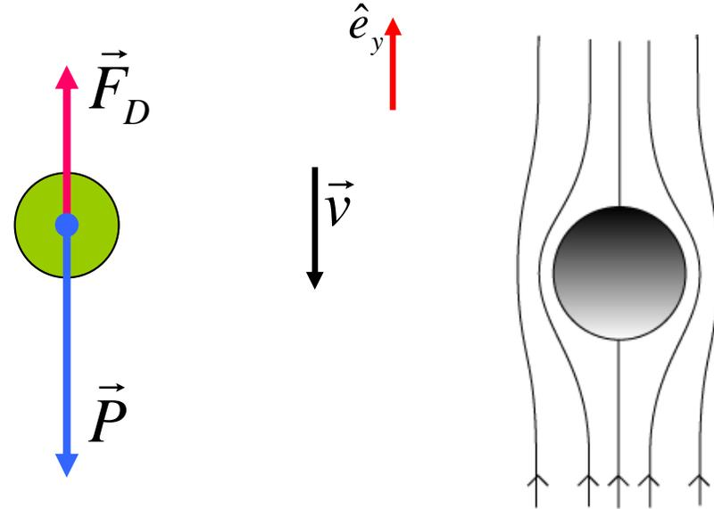
A força de resistência do ar para o escoamento laminar é do tipo viscoso. Quando a velocidade aumenta acima de um certo limite (escoamento turbulento) a força de resistência é essencialmente aplicada na massa de ar para que este saia do caminho do sólido.
